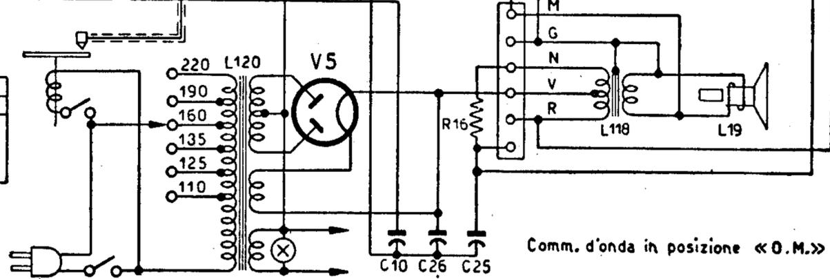
**ATTENZIONE** - A partire dalla matricola N. 12931 le valvole 6SA7 e 6SK7 vengono sostituite rispettivamente dalle valvole miniatura 6BE6 e 6BA6.
